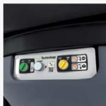
Boîtier électromécanique démontable sans outils
